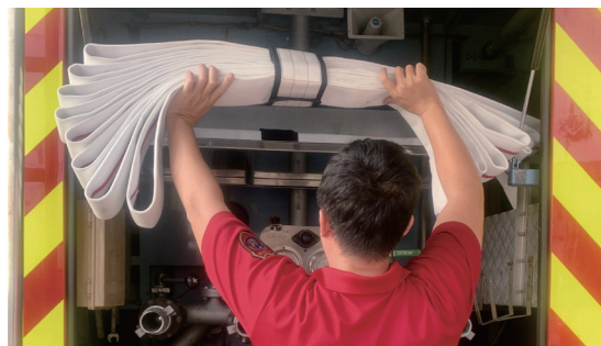
圖6、將水帶收納平台朝車頭方向前傾，以利於水帶穩定牢固
